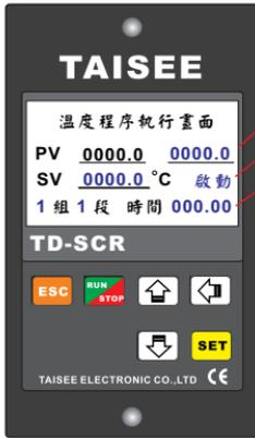
PV 100.0 檢測(輸入)溫度值顯示
